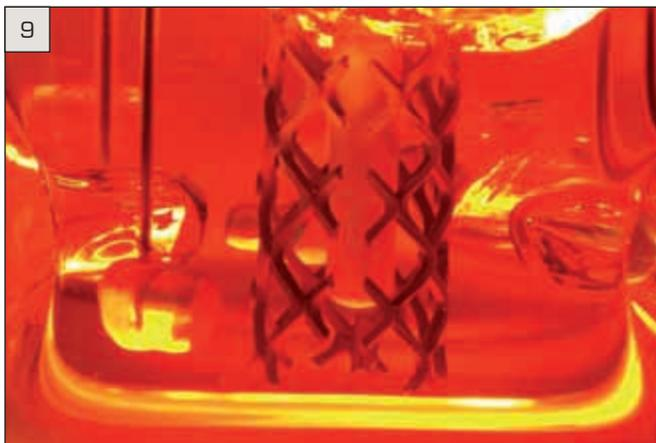
nem speziellen Galvanowachs und die Stellen mit Silberleitlack bestrichen. Der Implantatpfosten wird zur Aufnahme in das Galvanogerät mit Patterresin-Kunststoff versehen. Bei einer
