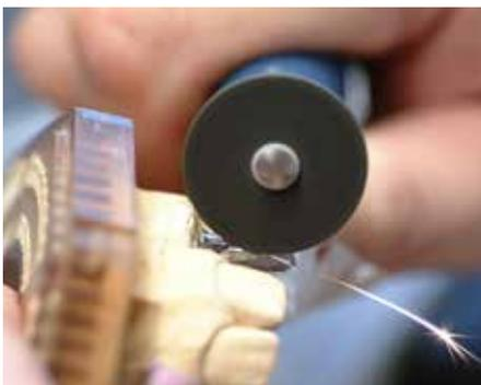
Die materialspezifische Bearbeitung der gefrästen Titanarbeit ist Voraussetzung für den Erfolg - wie bei jedem anderen Material auch.
